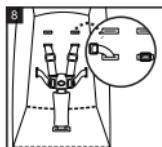
Установка ремня безопасности: Вставьте пряжкустор в отверстие и выровняйте пряжку сзади.
